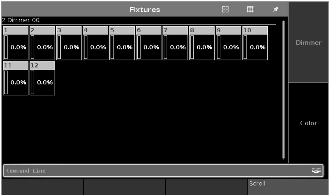
Jedes Rechteck ist ein Fixture. Der aktuelle Wert beträgt 0%, das heißt sie sind ausgeschaltet. Dieser Wert ist der Standard Wert. Das heißt wenn kein anderer Wert eingestellt wird, bleibt der Wert auf 0%.
