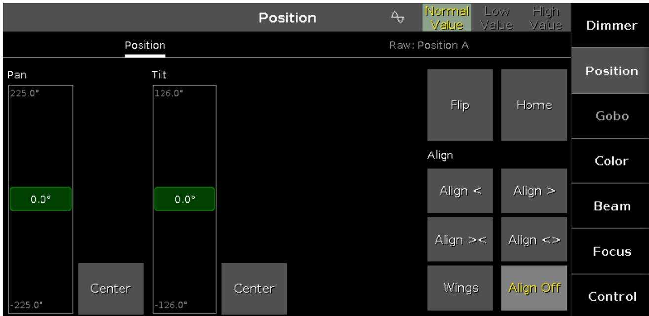
Der Position Preset Type View ist in die Bereiche **Position View** und **Direkt Position View** aufgeteilt.
