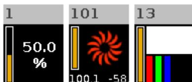
Alle Fixture Symbole zeigen die Fixture ID in der oberen linken Ecke und darunter die orangefarbene Dimmerleiste. Die Dimmerleiste zeigt den Wert des Dimmer Attributs grafisch an.
