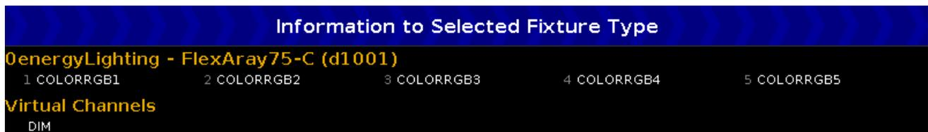
Hier wird zuerst der Hersteller, der Name des Gerätes und der Modus eines Fixture Types angezeigt.
