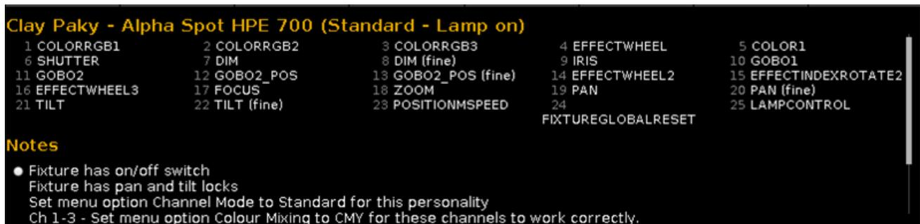
Zuerst wird der Hersteller, der Name und der verwendete Modus des ausgewählten Fixture Types gezeigt. Darunter finden Sie eine Auflistung der benötigten DMX Kanäle mit deren Attributen.
